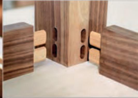
創新型定位系統：使用 DF 700 的整合式定位針，即使木樺組也從能從參照邊出發快速精確地定位。
