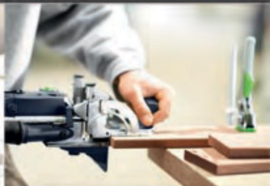
薄到連 12 mm 的工件也能輕鬆連接，完美適用於抽屜側板的製造。
