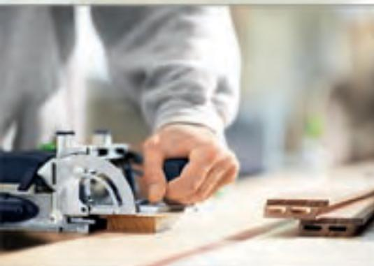
從第一塊多米諾木榫起，就能防止框架邊角扭轉，確保連接安定穩固。
